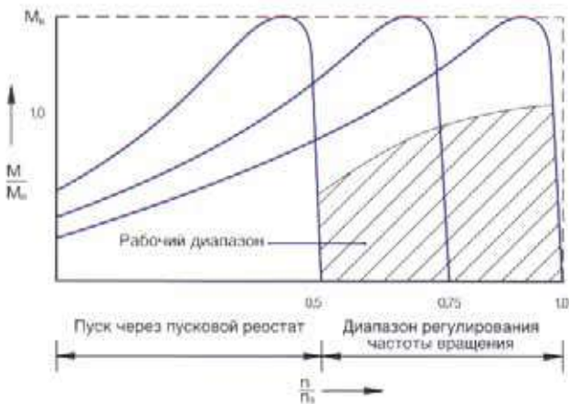
а) с подсинхронным преобразовательным каскадом
