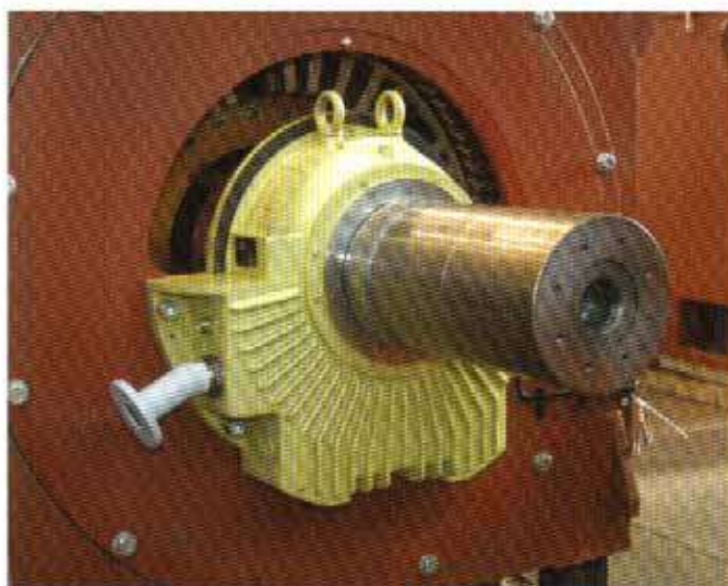
Узел подшипника, монтированный на подшипниковом щите
