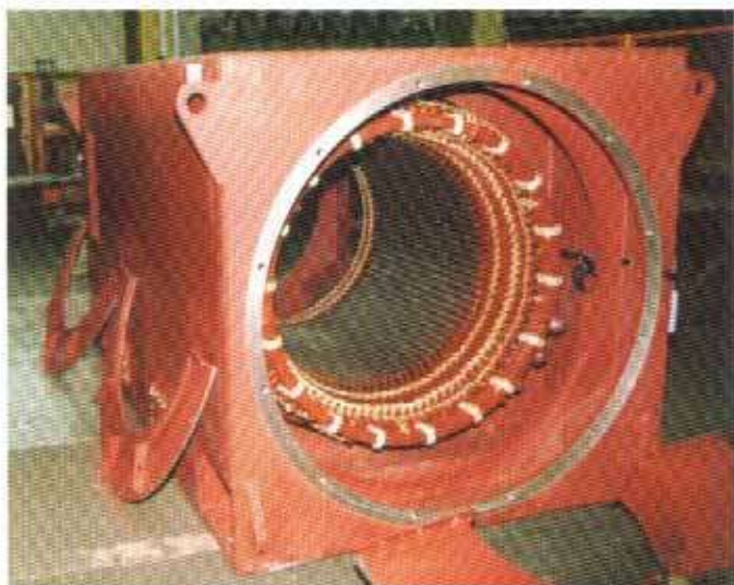
Сварной корпус во время монтажа
