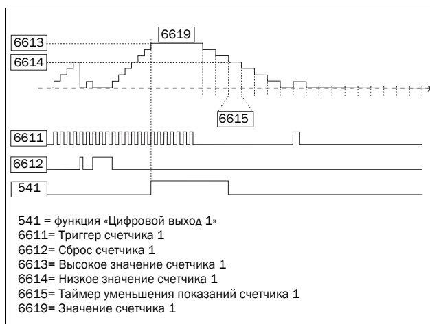
Рис. 54 Счетчики, принцип действия.
