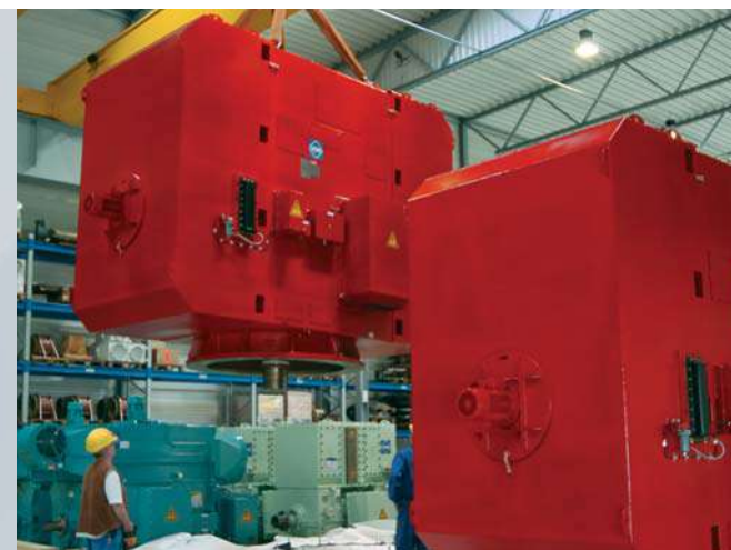
Проект "Судно-трубоукладчик Solitaire" DTMTZ 9038-6Y 4 300 кВт, 2 x 1.250 В, 465 мин -1 , IM 3011, IC 8A6W7
