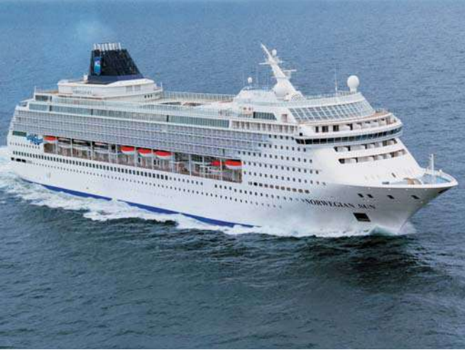
Проект “Norwegian Sun”, судостроительный завод Lloyd/Германия DTMYZ 3070-16 15 000 кВт, 2 x 2 900 В, 0 – 140 мин -1 , IM 7315, IC W37A97
