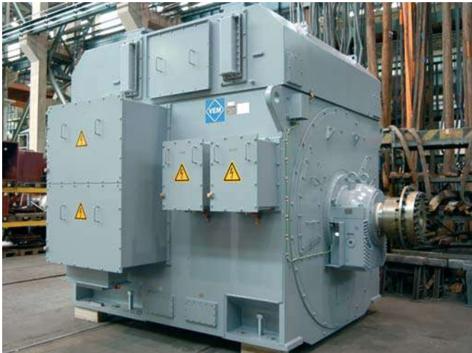
Проект “BC-Ferries” Судостроительная компания Flensburger Schiffbau Gesellschaft/Германия DRKSX 1036-12WS 4 800 кВА, 6 600 В, 600 мин -1 , IM 1101, IC 8A1W7
