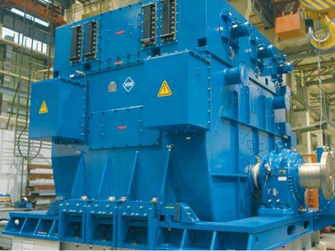
Проект “Seabourn”, Судостроительный завод Mariotti/Италия DTMSZ 2549-16YS 7 500 кВт, 2 x 2 500 В, 0 – 170 мин -1 , IM 7315, IC 8A6W7
