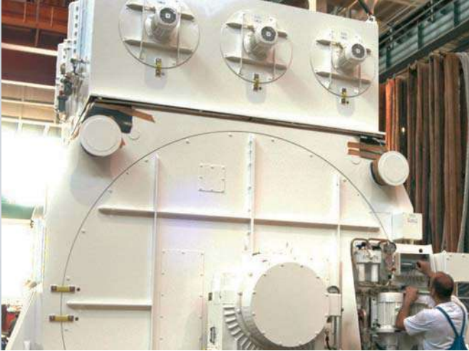
Проект “Мега-яхта”, Судостроительный завод Blohm+Voss/Германия DTMSZ 2542-16YS 6 500 кВт, 2 x 1 900 В, 0 – 180 мин -1 , IM 7315, IC 8A6W7
