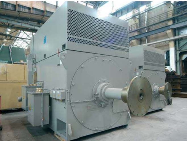
Привод мельницы Высоковольтные асинхронные двигатели трехфазного тока с фазным ротором 4000 кВт, 11000 В, 994 min -1
