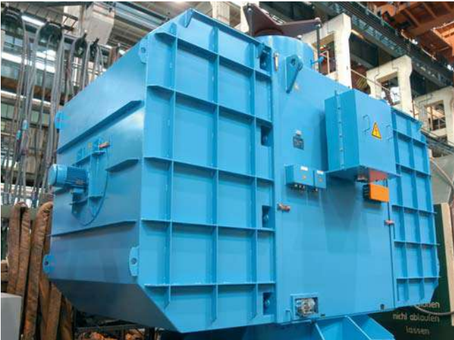
Привод для насоса Высоковольтный асинхронный двигатель с короткозамкнутым ротором 2550 кВт, 6000 В, 331 min -1
