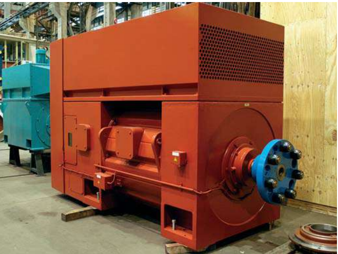
Привод ударно-молотковой дробилки Высоковольтные асинхронные двигатели трехфазного тока с фазным ротором 2700 кВт, 6600 В, 992 min -1
