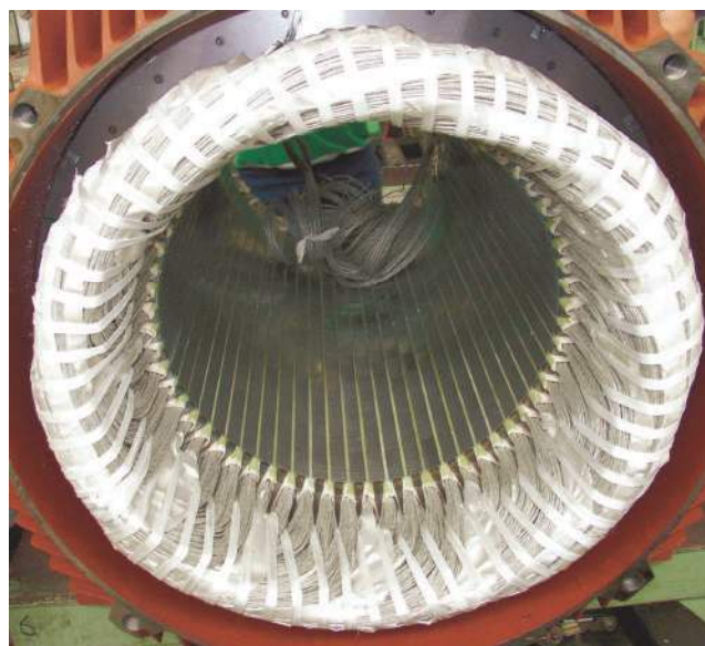
Типоразмер KV.R, обмотанный, непропитанный пакет статора
