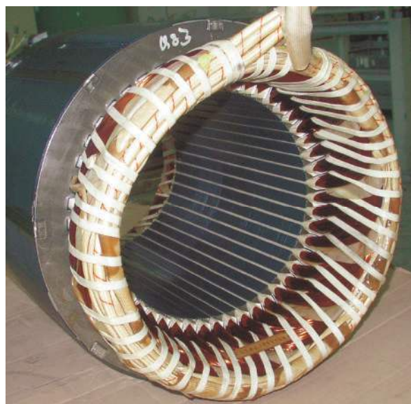
Типоразмер KU.R, пропитанный пакет статора
